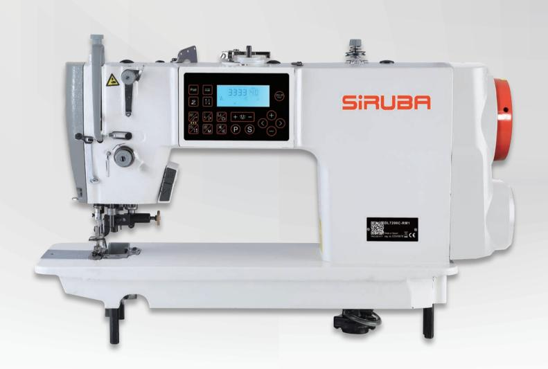
采用内置式直驱伺服马达,实现了机器的快速启动和制动的精确度:大幅度降低了噪音和振动,并降低了能耗,与普通的驱动装置相比,电量耗减35%以上,适用於缝制各类衬衫、西服或类似服装。特别是其衣领、前襟等部位,高速缝制时倒顺送料针距能保持完全一致,侧切刀装置使缝纫和修刀工序一次完成,工作效率提高。
